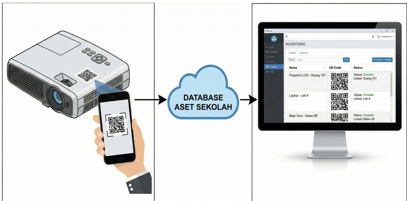
Gambar 2.4: Mekanisme pelacakan aset sekolah menggunakan QR Code .
